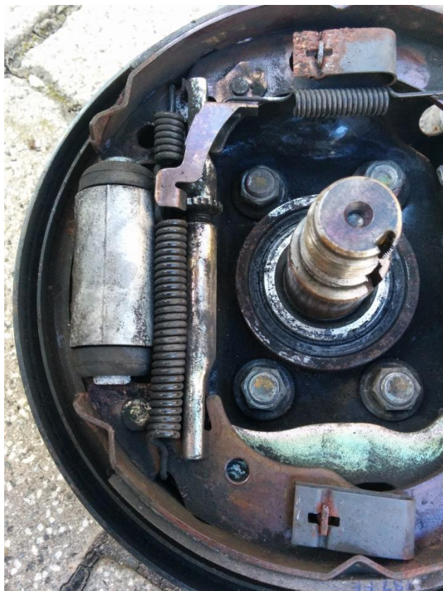
Einblick in eine Bremstrommel. Auf Undichtigkeiten und Gängigkeit des Radbremszylinders achten.
