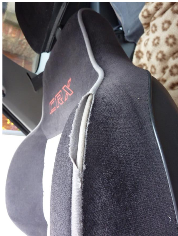
AS-Sitze, Beschädigte Keder.
