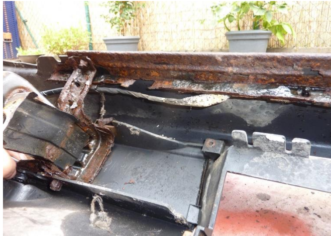
Innenleben der Heckstoßstange, stark angerostet
