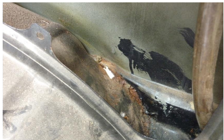
Innenraum, bei komplett abgebauter Innenverkleidung. Hier freie Sicht auf die Durchrostungen.
