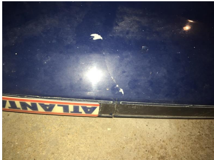
Riss in einem Kotflügel, bei der Verschraubung ( nicht sichtbar ) bis in die Mitte der Außenseite.
